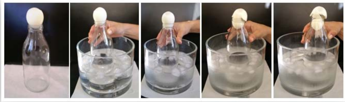
Εικόνα 2. Διαδοχικά στιγμιότυπα της εισαγωγής του αβγού μέσα στο μπουκάλι. (Φωτογραφίες Π. Στεφανίδου).
