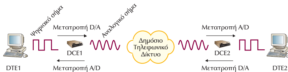
Σχήμα 5-2 Επικοινωνία τερματικών συσκευών DTEs με χρήση modems (DCEs) μέσω του Δημόσιου τηλεφωνικού δικτύου. Στο σχήμα, έχει σημειωθεί και η μετατροπή A/D ή D/A, που γίνεται στο σήμα
