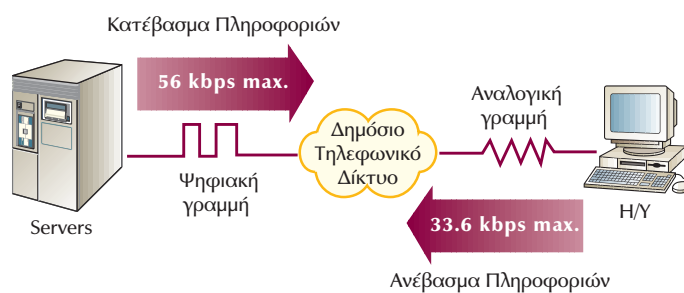
Σχήμα 5-3 Σύνδεση υπολογιστών με V.90 modem, σε Παροχέα Υπηρεσιών Διαδικτύου, κάνοντας χρήση του δημοσίου τηλεφωνικού δικτύου (α) Τοπολογία διασύνδεσης (β) Μετατροπές A/D ή D/A που γίνονται στο σήμα εάν χρησιμοποιούνται modem V.90 ή V.34 (γ) Απεικόνιση της ασυμμετρικής σύνδεσης στην περίπτωση χρησιμοποίησης V.90 modems
