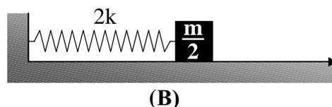
36. Ο απλός αρμονικός ταλαντωτής του σχήματος εκτελεί ταλάντωση πλάτους  $x_0$ . Διατηρούμε σταθερό το πλάτος ταλάντωσης και διπλασιάζουμε τη μάζα του σώματος. Με ποιο ή ποια από τα παρακάτω συμφωνείτε ή διαφωνείτε και γιατί;
