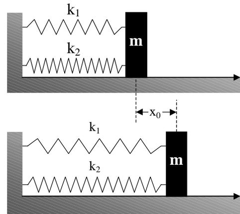
60. Δύο ιδανικά ελατήρια με σταθερές  $k_1 = 200 \text{ N/m}$  και  $k_2 = 300 \text{ N/m}$  συνδέονται σε σειρά. Το ένα άκρο του συστήματος που προκύπτει συνδέεται ακλόνητα με κατακόρυφο τοίχο και το άλλο συνδέεται με σώμα μάζας  $m = 0,3 \text{ kg}$ . Το σύστημα ισορροπεί πάνω σε λείο οριζόντιο επίπεδο, όπως φαίνεται στο σχήμα. Απομακρύνουμε τη μάζα από τη θέση ισορροπίας της κατά τη διεύθυνση του άξονα των ελατηρίων κατά  $x_0 = 0,2 \text{ m}$  και την αφήνουμε ελεύθερη.
