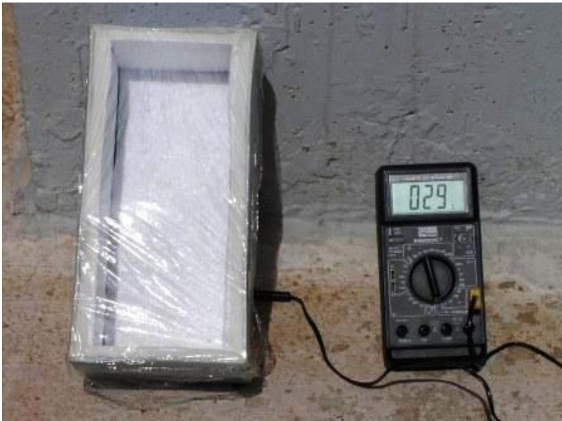
Μέτρηση της θερμοκρασίας στον ηλιακό φούρνο με ψηφιακό θερμόμετρο.
