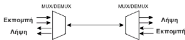
Σχήμα 4.9: Εκπομπή/Λήψη σε μία Οπτική Ίνα [2]
