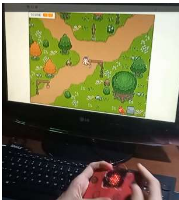
Εικόνα 2: Χρήση πλακέτας Micro:bit για την διαχείριση του παιχνιδιού
