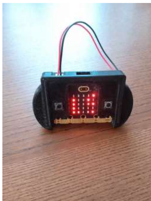
Εικόνα 3: 3D printed βάση για την πλακέτα Micro:bit
