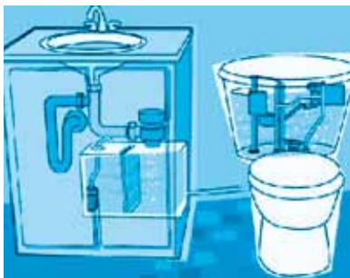
Εικόνα 8: Εγκαταστάσεις επεξεργασίας γκρίζων νερών
