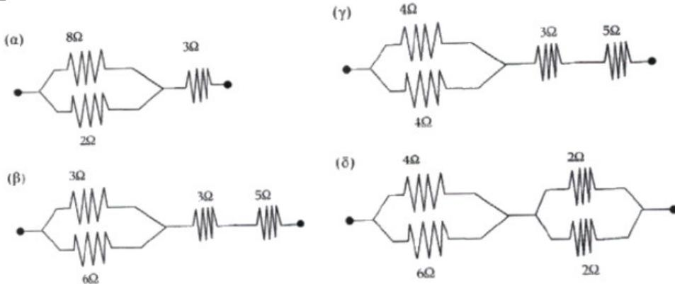
Αλ. α.  $R_{ολ} = 4,6 \Omega$  β.  $R_{ολ} = 10 \Omega$  γ.  $R_{ολ} = 10 \Omega$  δ.  $R_{ολ} = 3,4 \Omega$
