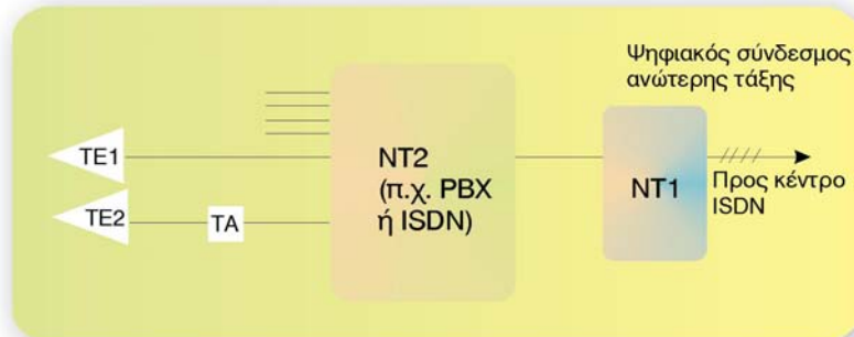
Σχήμα 8.4: Σύνδεση συνδρομητών ISDN μεγάλου φόρτου. Η χρήση της συσκευής NT2, που μπορεί να είναι ένα ψηφιακό κέντρο PBX ή ISDN στις εγκαταστάσεις του πελάτη, προϋποθέτει την εγκατάσταση από την πλευρά του φορέα της συσκευής NT1. Η συσκευή NT1 συνδέεται με το κέντρο ISDN του φορέα με ψηφιακό σύνδεσμο ανώτερης τάξης, που περιλαμβάνει πολλές τετρασύρματες ψηφιακές γραμμές.
