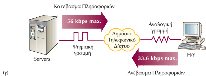
Σχήμα 5-3 Σύνδεση υπολογιστών με V.90 modem, σε Παροχέα Υπηρεσιών Διαδικτύου, κάνοντας χρήση του δημόσιου τηλεφωνικού δικτύου (α) Τοπολογία διασύνδεσης (β) Μετατροπές A/D ή D/A που γίνονται στο σήμα εάν χρησιμοποιούνται modem V.90 ή V.34 (γ) Απεικόνιση της ασυμμετρικής σύνδεσης στην περίπτωση χρησιμοποίησης V.90 modems
