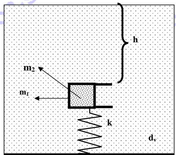
τριβές. Στη θέση ισορροπίας του συστήματος, το αέριο He έχει όγκο  $V_0$ , το έμβολο βρίσκεται σε βάθος  $h$  κάτω από την ελεύθερη επιφάνεια του νερού και το ελατήριο είναι συσπειρωμένο (βλέπε εικόνα). Το ύψος του εμβόλου είναι πολύ μικρότερο του ύψους  $h$ . Το σύστημα εκτρέπεται από τη θέση ισορροπίας του, κατά  $x$ , προς τα κάτω και αφήνεται ελεύθερο να κινηθεί.
